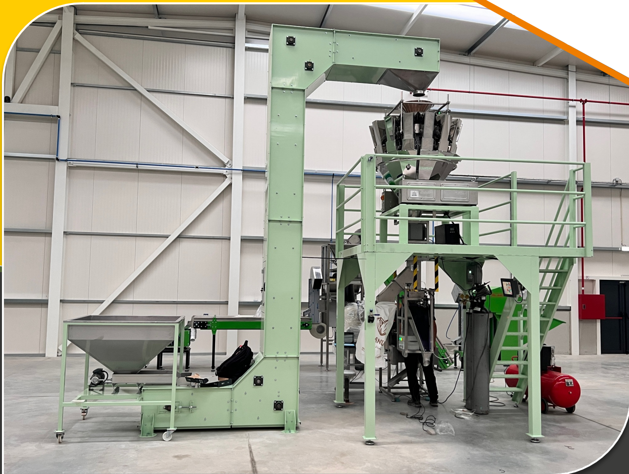
NutVision Linii de ambalare a miezului de nucă cu cântărire combinată cu 14 capete
