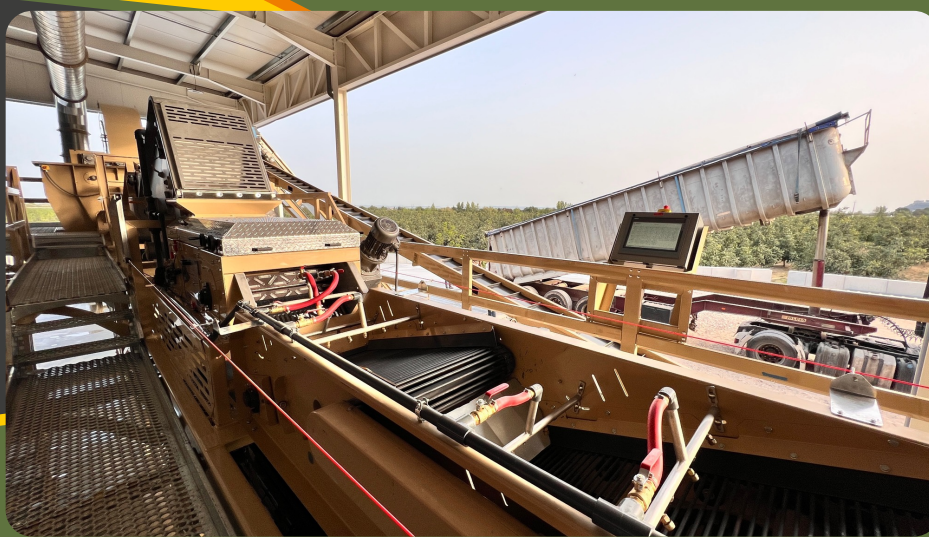
JESSEE Sisteme de spălare a benzilor transportoare și panoul de control principal
